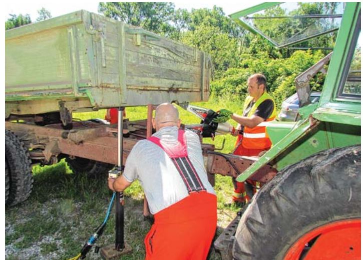
Technische Hilfe war hinter dem Alten Rathaus in Welschingen zu leisten, wo eine Person unter dem Kipper eines landwirtschaftlichen Gespanns eingeklemmt war. Mit einem hydraulischen Spreizer wurde die Ladefläche hochgedrückt, um den Eingeklemmten befreien zu können. Weitere Übungsannahmen der Gesamtübung waren die Notbefreiung aus einem Aufzug im Gymnasium Engen und das Löschen eines Brandes mit einem Kohlendioxid-Löschler, der Alarm einer Brandmeldeanlage im Städtischen Museum in der Klostersgasse sowie eine vermisste Person außerhalb von Welschingen. Bilder: Hering
